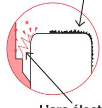
L'arc électrique élimine les dépôts de carbone
