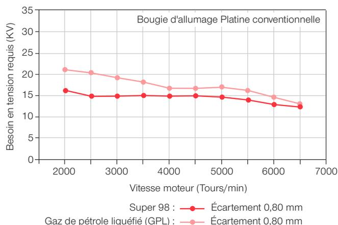
**Le voltage requis pour le fonctionnement d'un moteur à mélange gazeux augmente de 7000 Volts.**
