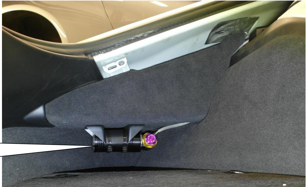
Ausgleichsbehälter mit Kabelbinder am Halter befestigen
