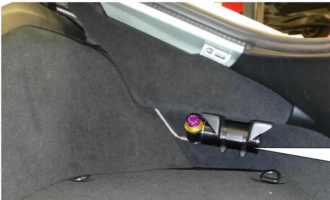
Ausgleichsbehälter mit Kabelbinder am Halter befestigen
