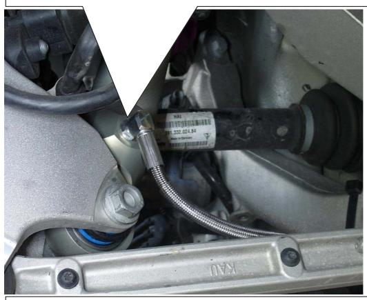
Druckausgleichsbehälter an der Strebe positionieren und mit Kabelbindern befestigen.
