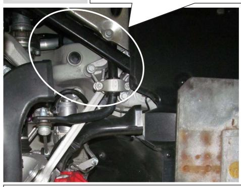
Montageposition Ausgleichsbehälter **mit Windlaufabdeckung**. Die Windlaufabdeckung muss für die Befestigung des Ausgleichsbehälters demontiert werden.
