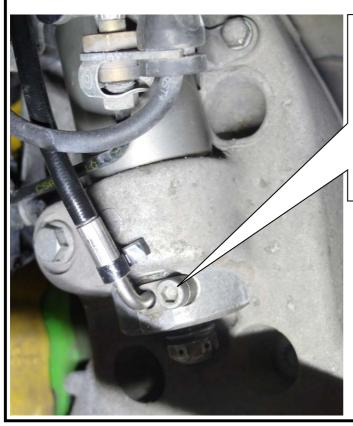
Bei Fahrzeugen **mit Serienlift** erfolgt der Anschluss der Pneumatikleitung an diesem Anschluss. Das Anzugsdrehmoment der Verschraubung entnehmen Sie bitte den Unterlagen des Fahrzeugherstellers.
