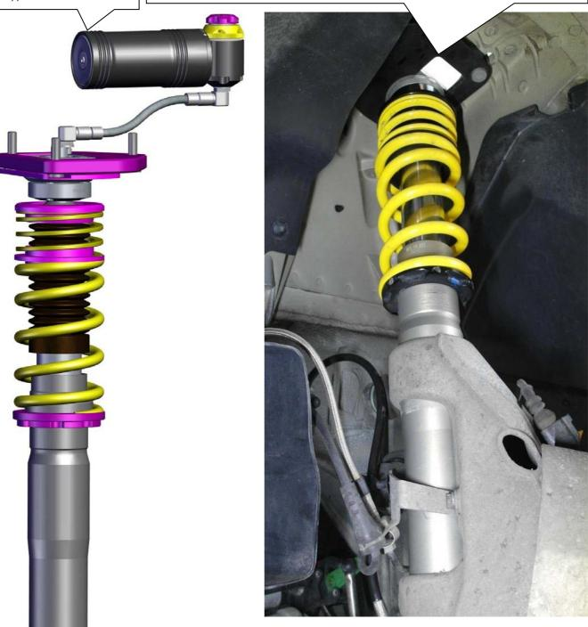
Das Federbein muss so gedreht werden, dass dieser Anschluss zur Fahrzeuginnenseite zeigt.
