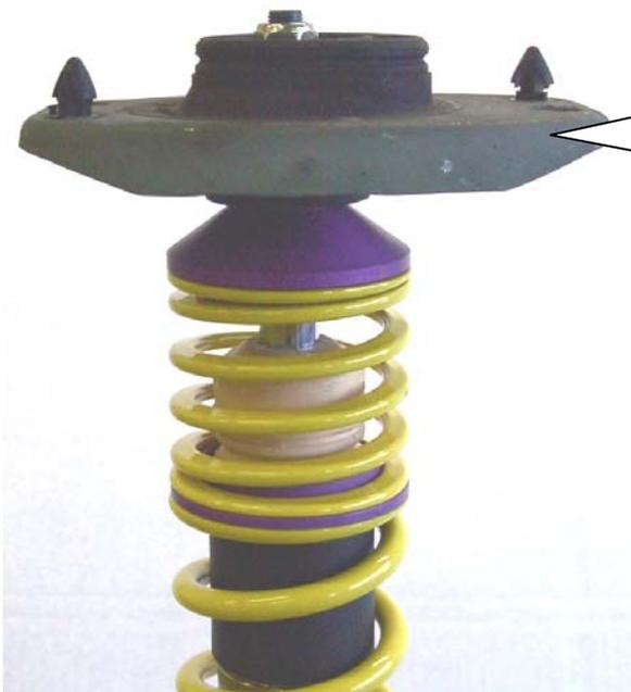
Das Original Domlager mit Distanzhülse, wie im Bild dargestellt, auf das angelieferte Federbein aufstecken und mit der mitgelieferten Stopmmutter verschrauben. Das Anzugsdrehmoment der Kolbenstangenbefestigung beträgt 35 Nm. Die Montagehinweise zum Einbau des Federbeines in das Fahrzeug, sowie die Anzugsdrehmomente der Federbeinbefestigung, entnehmen Sie bitte den Unterlagen des Fahrzeugherstellers.
