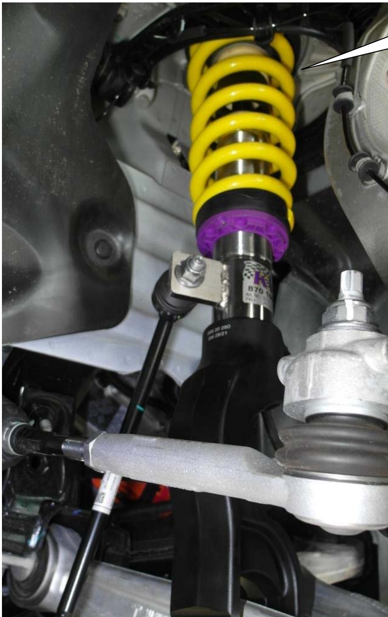
Montiertes Federbein. Installed coilover strut.
