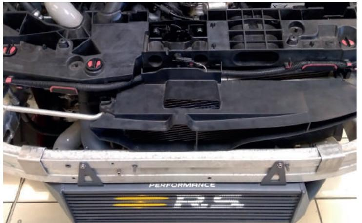
**FR** 33. Mettez la patte de l'écope de l'échangeur en place à l'endroit indiqué par le cercle rouge et marquer le trou de montage sur la poutre anti choc.
