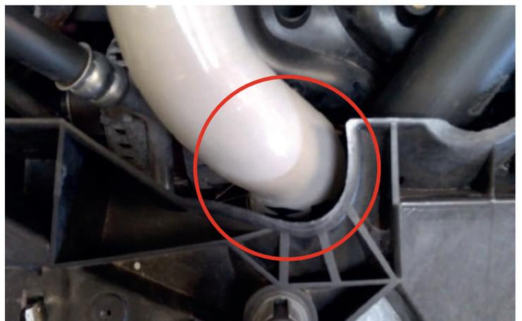
**FR** 31. Tracez une marque de découpe, comme indiqué sur l'image sur l'écope de l'échangeur pour l'insérer avec votre nouvel échangeur. Coupez à l'aide d'une disqueuse équipée d'un disque à découper ou à l'aide d'un cutter. Cette opération nécessite une attention particulière pour effectuer la découpe en toute sécurité.
