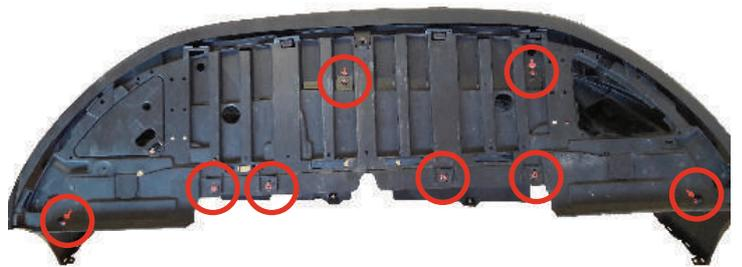
**FR** 5. Déposez les clips de chaque passage de roues. Il y en a quatre au total. Puis déposez les passages de roues.
