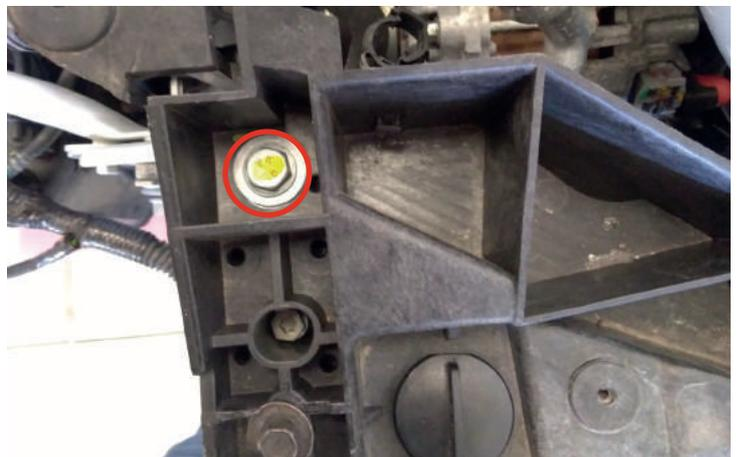
**FR** 17. Retirez les deux clips du radiateur et celui de l'échangeur sur la traverse en les tournant dans le sens antihoraire, puis retirez le faisceau de sécurité du capot.
