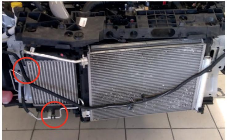
**FR** 16. Dévissez les deux vis du support d'échangeur à l'aide d'une douille de 13mm, puis déposez la traverse.
