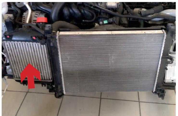
**FR** 23. Marquez les trous pour le montage du nouvel échangeur comme indiqué. Commencez par le trou côté conducteur (véhicule conduite à gauche). Faites les trous de montage avec un foret de 7mm.
