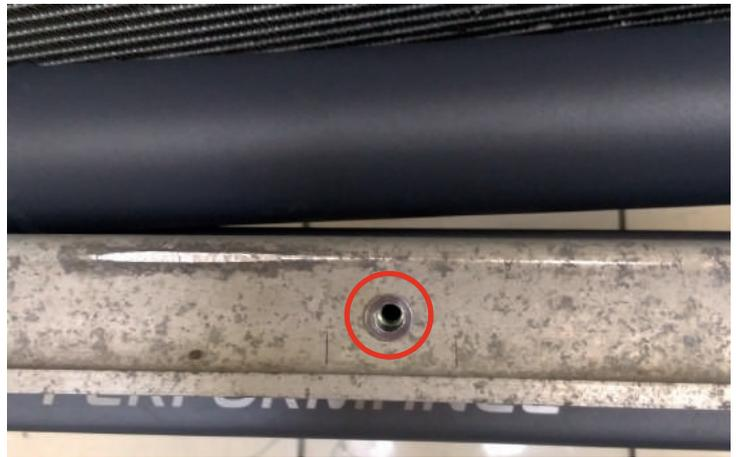
**FR** 36. Fixez la patte de l'écope de l'échangeur avec une vis M5 et une rondelle Onduflex à l'aide de la clé Allen de 3mm.
