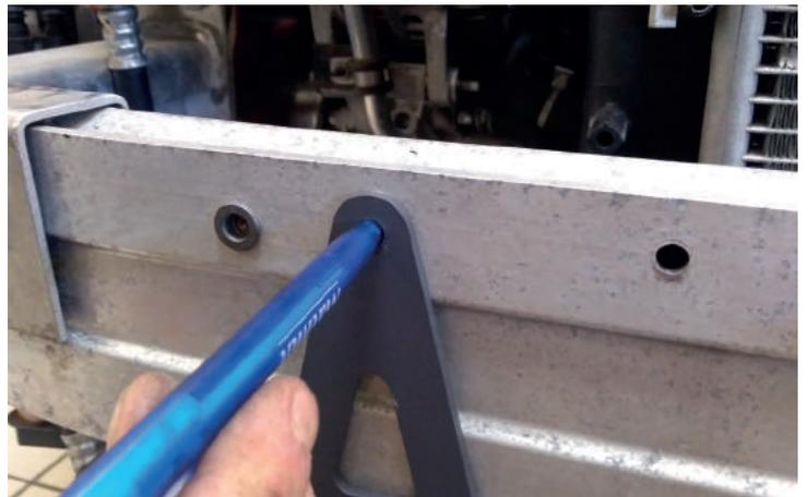
**FR** 25. Faites le second trou à l'aide du foret de 7mm, et mettez en place la seconde vis à tête Allen de 6mm. A l'aide de la clé Allen de 6mm et de la douille de 10mm, serrez les deux vis.
