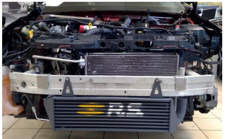
**FR** 26. Installez le coude à 90° en silicone et le tuyau rigide du côté conducteur (véhicule conduite à gauche). Ne serrez pas les colliers à ce stade du montage.
