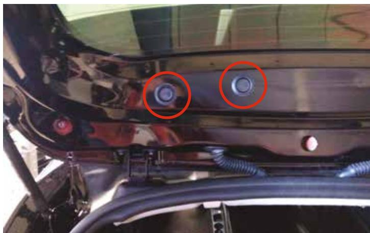
**FR** 2. Maintenant vous avez accès aux écrous de fixation, retirez-les à l'aide du tournevis T25, le cliquet et une douille de 8 mm.
