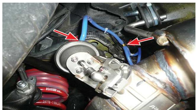
Conectar la valvula de depresión del escape derecho, utilizando le segundo embrague "T" incluido en el kit, para dividir el tubo de goma en dos.
