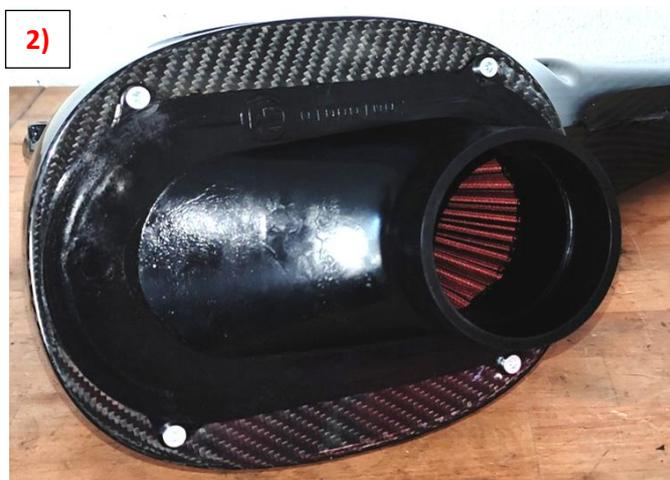
Führen Sie die vormontierte Airbox unter dem Wasserschlauch in den Bauraum. Platzieren Sie die Airbox am Schlossträger so, dass die Verschraubpunkte übereinstimmen, bevor Sie die Airbox unten in das Gummilager drücken. Verschrauben Sie die mitgelieferten M5x20mm Innensechskant Senkkopfschrauben mit den Senkkopf Unterlegscheiben an den vorderen Punkten. **(3)**
